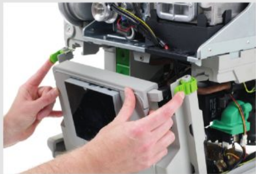
Clips de fixation du tableau électrique facilement identifiables et manipulables
