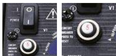
Interrupteur d'alimentation, câble et disjoncteur
